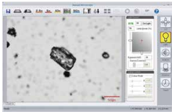
指定した粒子の位置へ自動的に移動し、レーザ光を照射してラマン分光法による化学同定を行います。
